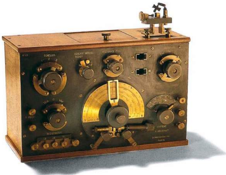
Contrôleur d'ondes à galène 1917 radiotélégraphie militaire, système Armagnat . 39 × 35 × 22
